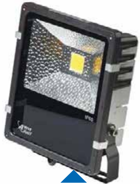
COSMOS 50 - AR5050-NW LED FLOOD LIGHT 55W 4.000°K Bianco naturale 4.300Lm 100° di angolo proiezione Colore corpo: grigio/nero Materiale: Alluminio / Vetro Connessione alimentazione a cavo IP65
