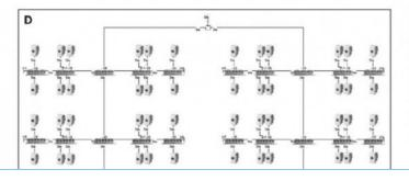
L'esempio D evidenzia la possibilità di effettuare impianti di dimensioni maggiori su diverse scale con unica centrale di testa.
